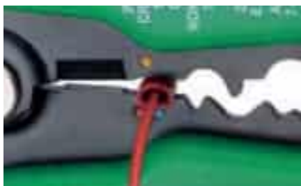
• Crimpatura di terminali isolati
